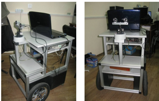
Рис. 1 – Мобильная сенсорная платформа с установленной стереопарой
